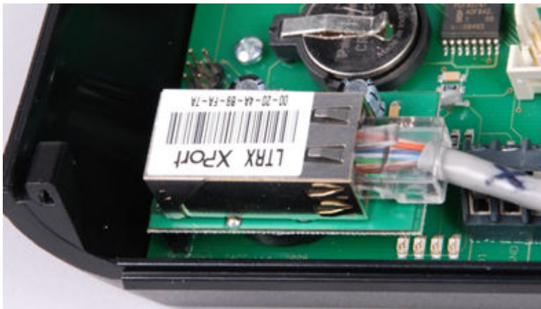
Obr.14: nasazený modul převodníku Ethernet – GiPort
