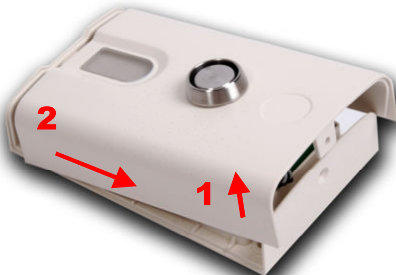
Obr. 3 Po uvolnění šroubu oddálit horní kryt od spodního ve směru a pořadí šipek.
